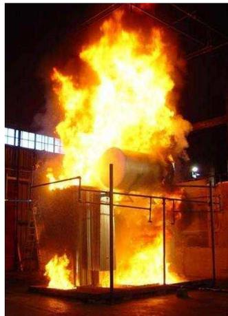
Figura 22 - Propagação do calor por irradiação
